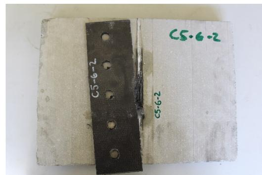
*Bruchbild eines Prüfkörpers: Das in Betonschlitz eingeklebte Laminat versagt durch Abscheren.*
