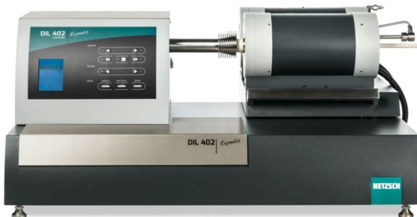
Abb.1: Hochtemperatur-Dilatometer DIL 402 Expedito ® Supreme von NETZSCH.
