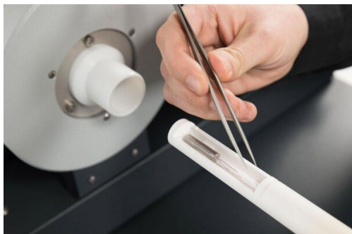
Abb.3: Probenvorbereitung in \text{AlO}_2 Halterung.
