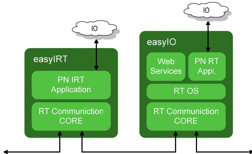
Als Basis für die Echtzeit-Kommunikation ist in der FPGA-Hardware der **RT Communication CORE** integriert. Dieser ist skalierbar und modular aufgebaut um alle Ansprüchen einer modernen Kommunikationsarchitektur optimal zu unterstützen.
