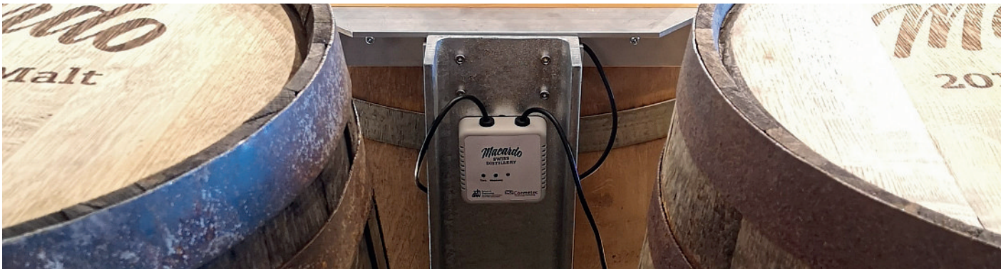
Sicht von unten: Das Sensormodul wird an der Fassaufhängung befestigt.
