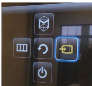
Der Knopf funktioniert ausserdem wie ein Joystick. Durch erneutes einmaliges Drücken erscheint ein kreuzförmiges Menü. Den Joystick nach rechts bewegen, damit „Quelle“ aktiviert ist.
