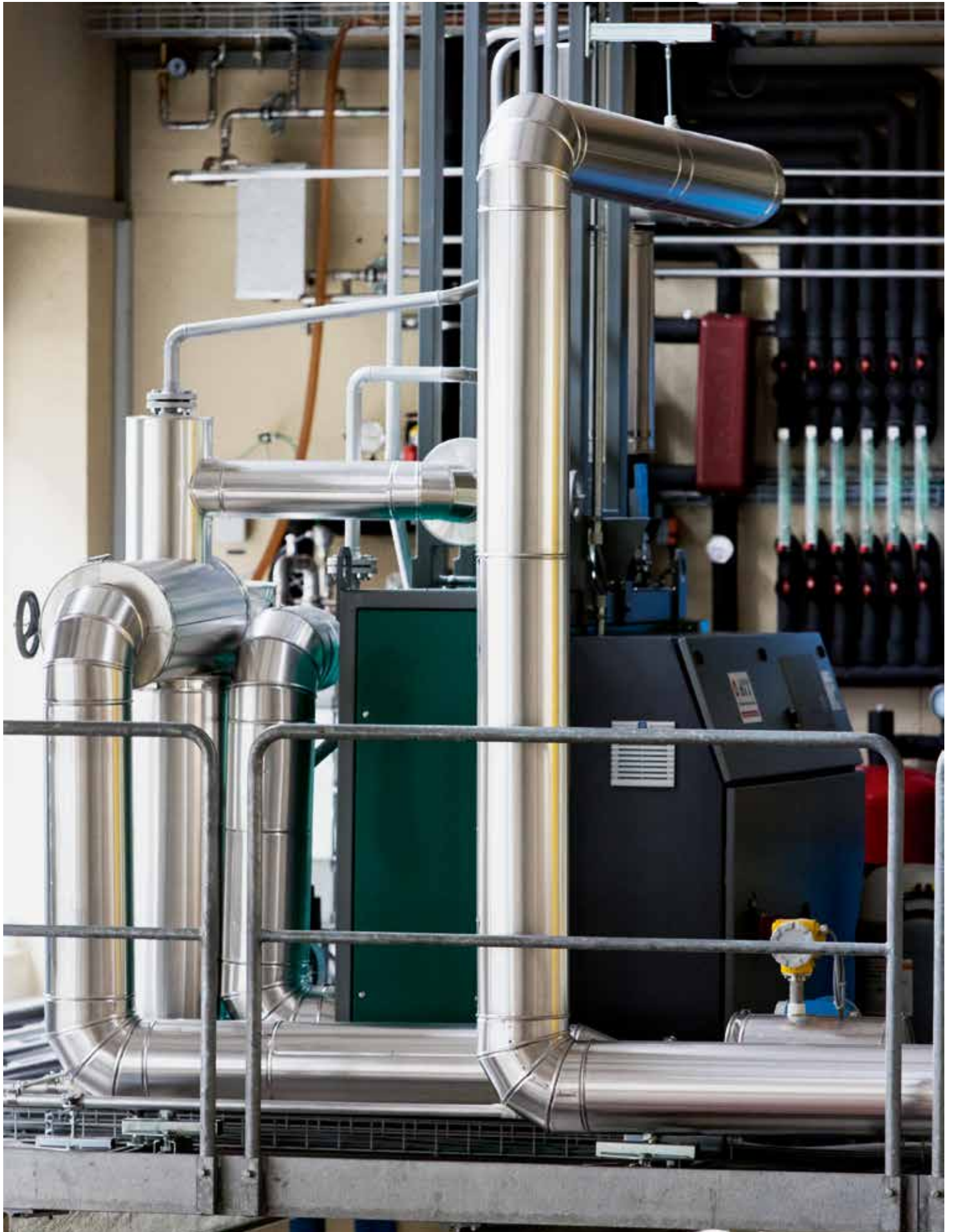
In den diversen Forschungslabors erhalten die Studierenden Einblick in zukünftsträchtige Technologien wie hier beim Organic Rankine Cycle, bei dem aus Industrieabwärme oder Wärmequellen mit niedriger Temperatur Strom gewonnen wird.
