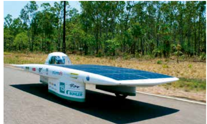
Mit der Kraft der Sonne unterwegs: Der Solar Racer muss möglichst leicht und aerodynamisch sein.
