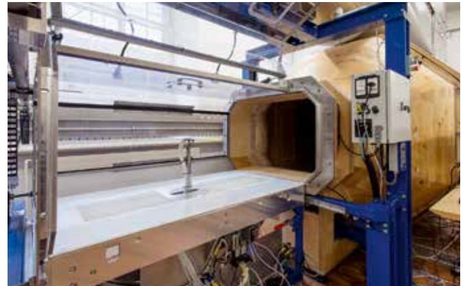
WINDKANAL ALFA Studierende erfahren in Praktika Grundlagen der Aerodynamik und setzen in Bachelorarbeiten eigene Projekte um. Der Bau und die Inbetriebnahme wären ohne sie auch undenkbar gewesen.
