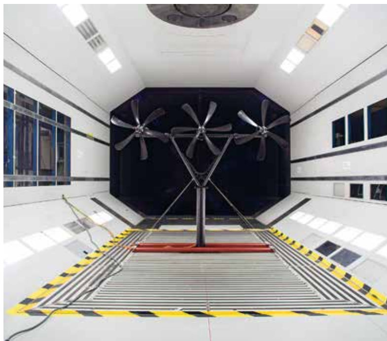
Die dreirotorige Windkraftanlage «Hans» hat eine installierte Leistung von 250 Kilowatt. Der Rotordurchmesser beträgt 14 Meter.
