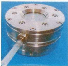
Reaktor zur biomechanischen Stimulation bei der Züchtung von Gewebe. Entwickelt an der ZHW
