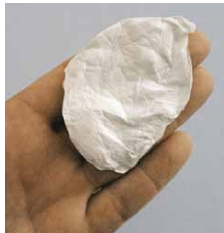
Nanofaser-Vlies aus einem biokompatiblen Polymer.
