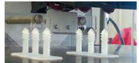
Abb. 1: Knochenschraubenmodell aus Polymilchsäure aus dem 3D-Drucker
