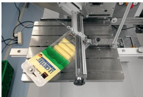
Abb. 1: Öffnungskraftmessung von peelbaren Verpackungen
