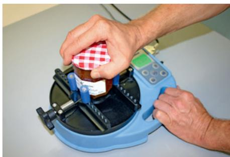
Abb. 2: Öffnungskraftmessung von Verpackungen mit Drehverschluss
