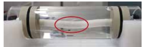
Abb. 3: Die Kammer, welche im IMES bei Prof. Dr. Daniel Baumgartner entwickelt wurde, erlaubt unter anderem die Einführung eines Stents in das konstruierte Gefäss
