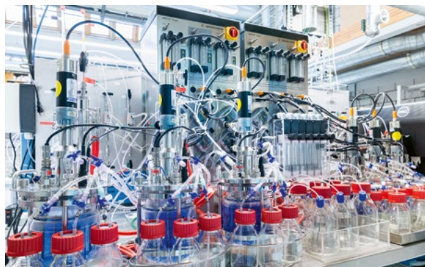
Laboranlage zur Biologischen Methanisierung in Rührkesselreaktoren der Fachgruppe Umweltbiotechnologie (Foto: Frank Brüderli)
