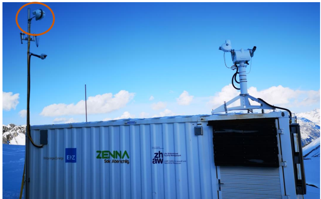
Abbildung 6: Vertikale Einstrahlungsmessung aus östlicher und westlicher Richtung, in Betrieb seit 1. Oktober 2020 am Messmast des Containers. Die Sensoren befinden sich oben links im Bild.
