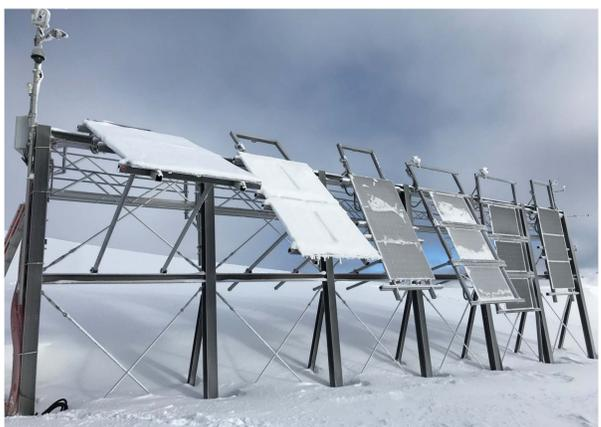
Abb. 1: Versuchsanlage in Davos-Totalp mit sechs Segmenten in verschiedenen Anstellwinkeln, Ausrichtung Süden und monofazialen und bifazialen Modulen.
