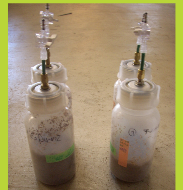
Abbildung 3: Versuchsflaschen (rechts: Referenz, links: F 10%Me 10%EM)
