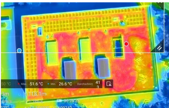
Abb. 3: Screenshot der Fernsteuerung der Wärmebild-Drohne von Dachbegrünungsaufnahmen im Sommer 2023. Die Temperaturdifferenzen im Vergleich zur Lufttemperatur bewegen sich zwischen 12 und 20 °C. (J. van Gogh)
