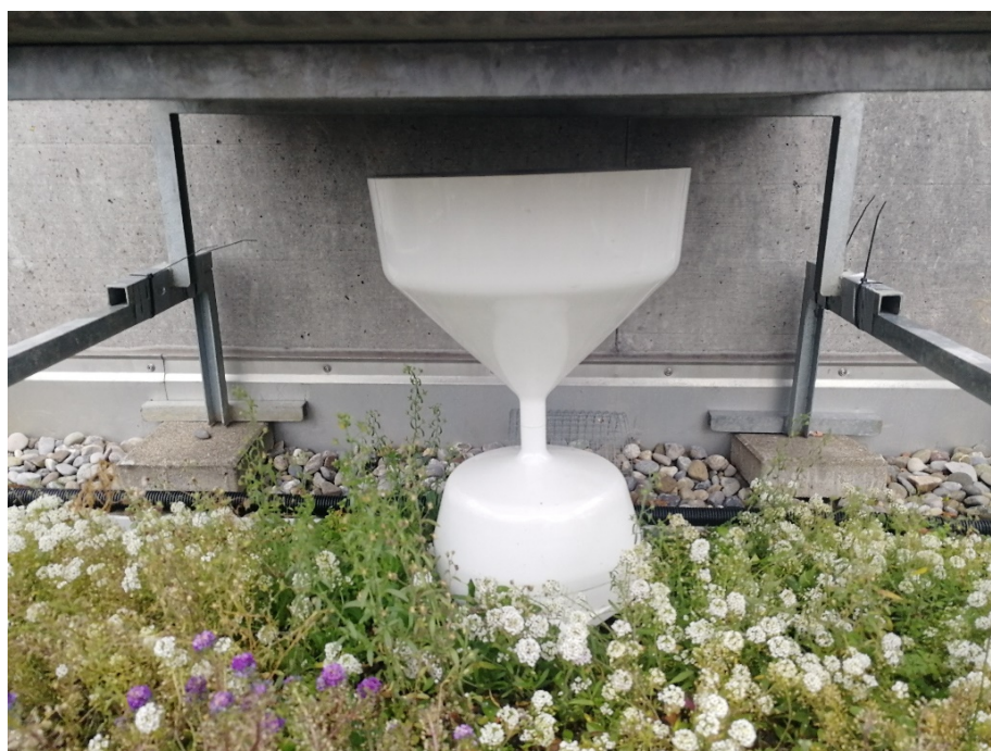
ABBILDUNG 3. EINER DER NIEDERSCHLAGSMESSER, DER DIE ABFLUSSMENGE DER TRÖGE MISST.
