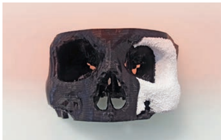
Abb. 1: Personalisiertes Knochenersatzimplantat basierend auf der 3D-Pulverdrucktechnologie am Beispiel eines Jochbeins.
