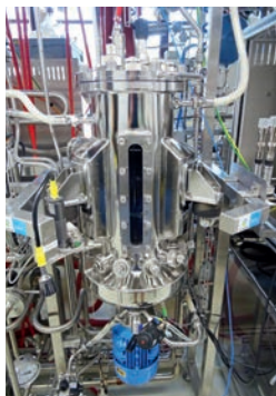
Abb. 1: Bioreaktor für die Kultivierung von Pichia pastoris
