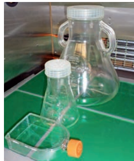
Abb. 1: Der Scale-up erfolgte von der T-Flasche in den 500 mL Kolben und anschliessend in den 5 L Kolben.
