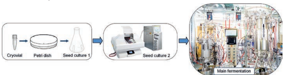
Abb.: Prozess-Flussdiagramm der Kultivierung im 30 L und 100 L Edelstahlbioreaktor.
