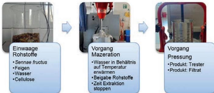
Abb.: Herstellverfahren Feigensirup mit Senna im Labor: Nach dem Abwägen der Rohstoffe folgt die Extraktion bei der eingestellten Temperatur und Zeit. Nach Ablauf der Extraktion wird das Gemisch mittels Handpresse gepresst, woraus das Filtrat und der Trester gewonnen werden.
