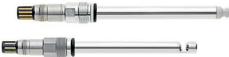
Abb.: Die für die Arbeit eingesetzten Zelldichtesensoren. Oben: Incyte für die Messung der Lebendzelldichte über die Permittivität. Unten: Dencytee für die Messung der Gesamtzelldichte über die optische Dichte.
