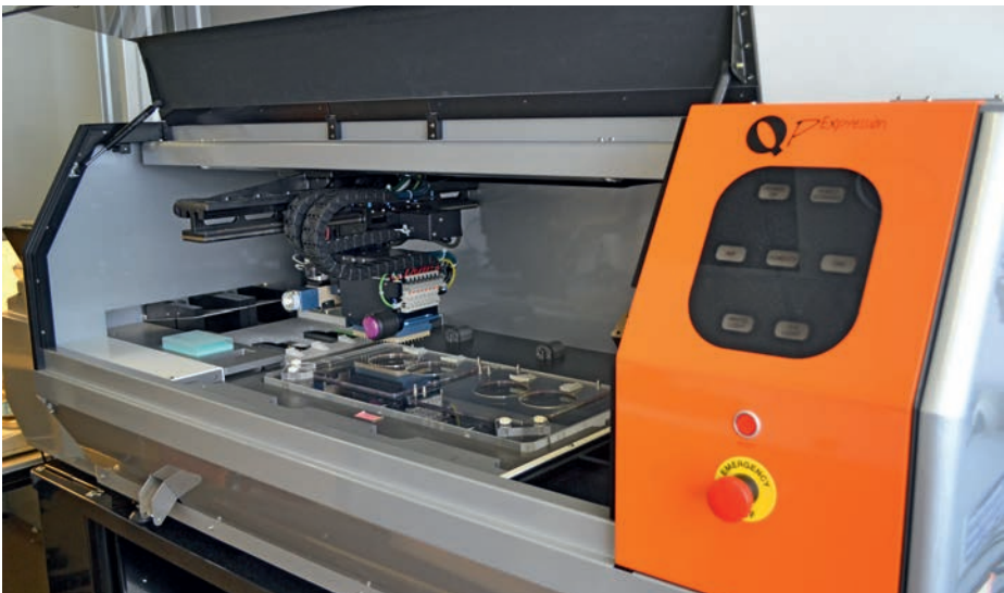
Abb.: Genetix QP Colony Picker für einen automatisierten Übertrag der Transformanten in ein 96-Wellformat.
