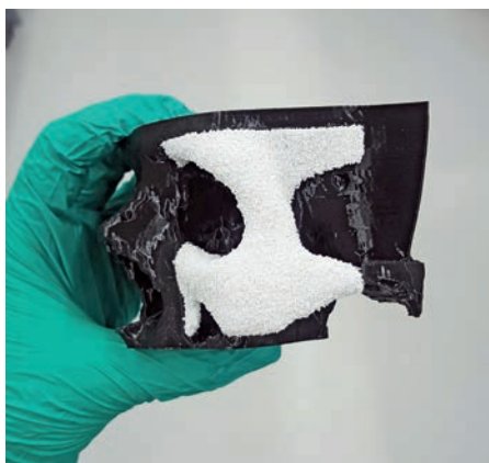
Abb. 2: Seitenansicht vom Mittelgesicht mit eingesetztem Jochbein. Material Mittelgesicht: Polymilchsäure (kurz PLA) schwarz, Technologie: 3D-FDM-Druck; Material Jochbein: polymerbeschichtetes \beta -Tricalciumphosphat (kurz \beta -TCP), Technologie: 3D-Pulverdrucktechnologie.
