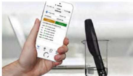
Abb. 2: Kommunikation zwischen der ISE und der App per Bluetooth
