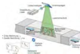
Abb. 1: Schematischer Messaufbau einer PIV-Anlage
