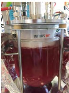
Abb. 1: Aufnahme des Labfors-Rührreaktors während der Kultivierungsphase
