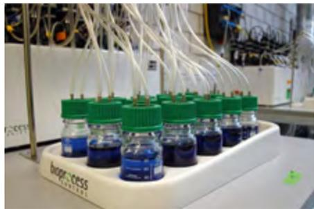
Abb. 2: Versuchsanordnung zur Messung des Biomethan-Potentials
