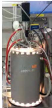
Abb. 2: Der 2L-Laborphotobioreaktor wurde für die Kultivierung unter kontrollierten, phototrophen Bedingungen eingesetzt.
