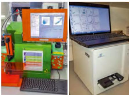
Abb.: (l.) MACSQuant Durchflusszytometer der Firma Miltenyi Biotec. Eine der verwendeten Geräteplattformen zur spezifischen Zellanalyse. (r.) Der Nucleocounter 3000 von Chemometec ist die zweite verwendete Geräteplattform. Anders als beim Durchflusszytometer handelt es sich hier um ein Fotografie-basiertes Analysensystem.
