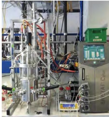
Abb.: Labor-Bioreaktor mit Kontrolleinheit
