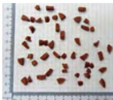
Abb. 1: Zerkleinertes Material einer untersuchten Verpackung vor der Extraktion. Die einzelnen Stücke haben eine Kantenlänge von ca. 0,5 – 1 cm.
