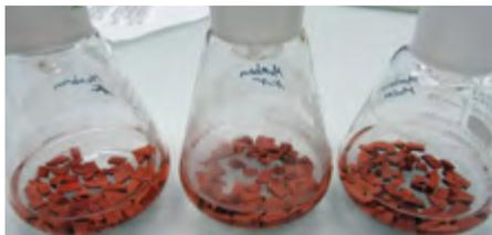
Abb. 2: Material in drei unterschiedlichen organischen Lösungsmitteln nach der Extraktion. Der Kunststoff wird anschliessend entfernt und die Probenflüssigkeit entsprechend aufbereitet.
