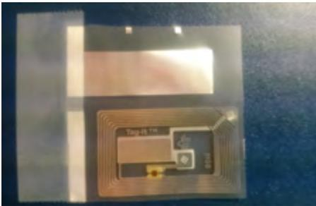
Abb. 1: NFC-Tag Tag-it HF-I Plus Transponder Inlay Typ RI-I03-112A von Texas Instruments
