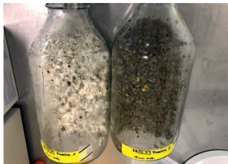
Abb. 3: Die Feststofffermentation im Labormassstab wurde in Schottflaschen durchgeführt. Zu sehen ist auf der linken Seite der ausgekeimte Pilz auf der Gerste und auf der rechten Seite eine Schottflasche, die aufgeschüttelt wurde.
