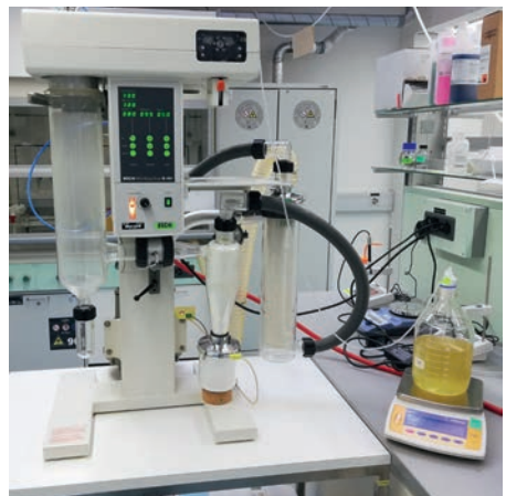
Abb. 2: Verwendeter BÜCHI Mini Spray Dryer B-191 für die Sprühtrocknung der Zein-Lösung.
