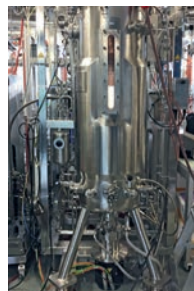
Abb. 3: D-DCU Rührreaktor mit einem Arbeitsvolumen von 100 Liter.
