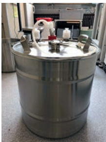
Abb. 1: Die Feststofffermentation wurde in eigens dafür konstruierten Fässern durchgeführt.
