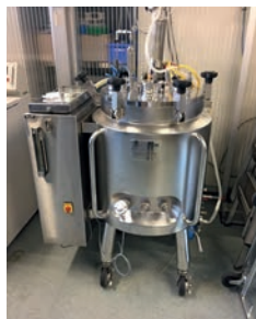
Abb. 2: MAVAG Pharma-Mischbehälter mit einem Arbeitsvolumen von 100 Liter.
