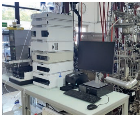
Abb. 1: Aufbau der Online-HPLC im Labor für Bioproszess-technologie.
