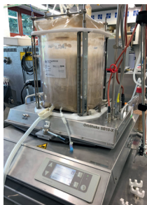
Abb. 2: Das Scale-up der Vorkultur erfolgte über einen orbital geschüttelten Bioreaktor.
