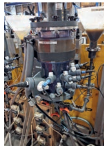
Abb. 1: Labor-Batchbioreaktor (12L) zur Bestimmung von N-Spezies-Abbauleistungen und Lachgasbildungspotenzialen.
