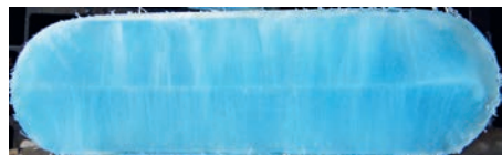
Abb. 3: Mithilfe eines Farbstoffes wurde die Kryokonzentration sichtbar gemacht. Die weisse Linie verdeutlicht, wie gleichmässig der Gefriervorgang von unten und oben verläuft.
