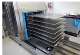
Abb. 2: Die Wärmeübertragungsplatten des Plate Freezer. Die Single-use Bags werden dazwischen platziert.
