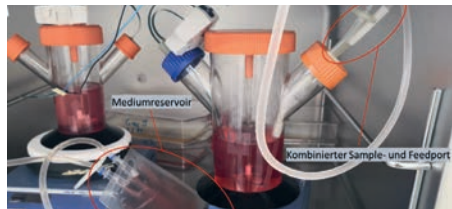
Abb. 2: Versuchsaufbau bei der CHO-Kultivierung. Rechts eine Spinnerflasche mit kombiniertem Sample- und Feedport (kleiner orangefarbener Deckel) und Glucose-Lactat-Sensor und pH-Sensor (kleiner blauer Deckel). Links eine kleine Spinnerflasche mit eingebauter Standardreferenz und mit Glucose-Lactat-Sensor und pH-Sensor.
