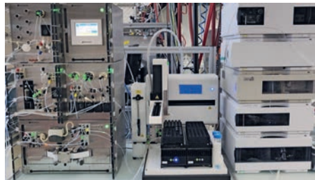
Abb. 2: Automatisiertes Probeentnahmesystem verbunden mit einem Hochleistungsflüssigkeitschromatographie-Gerät.
