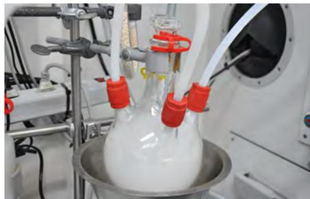
Abb. 2: Abgas mit Schwefeltrioxid Aerosol.
