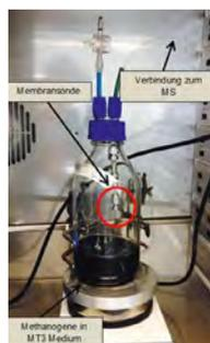
Abb. 2: Kontinuierliche Messung einer Methanogenese (Batch) mit einem MIMS System bei 55 °C.
