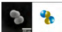
Abb. 1: REM-Aufnahme: JNP mit einem Lappenverhältnis von 1:1. Die beiden Lappen weisen unterschiedliche chemische Eigenschaften auf.
