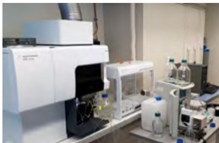
Abb. 2: Die Speziesanalytik von Cr(III) und Cr(VI) wurde durch Kopplung der Ionenchromatographie mit der Plasma-Emissionsspektrometrie durchgeführt.
