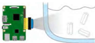
Abb. 2: Aufbau zur Kristallisationsüberwachung mittels CCD-Kamera (Schema).
