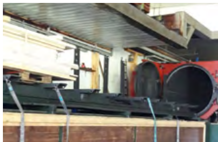
Abb. 1: Anlage zur Kesseldruckimprägnierung von Holzprodukten für Spielplätze und den Gartenbereich.
