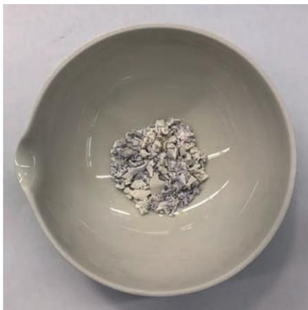
Abb. 2: Silbermodifizierte TiO<sub>2</sub>-Partikel. Das Silber ist nicht homogen auf dem Titandioxid verteilt.
