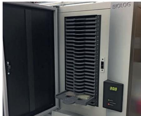
Abb. 1: Mittels Omnilog (Biolog), einem vollautomatischen Inkubier- und Lesegerät, können bis zu 50 Microdilution Tests gleichzeitig durchgeführt werden.
