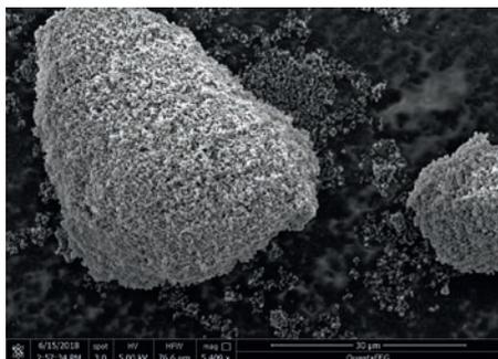
Abb. 1: REM-Aufnahme eines synthetisierten, silbermodifizierten TiO<sub>2</sub>-Partikels.
