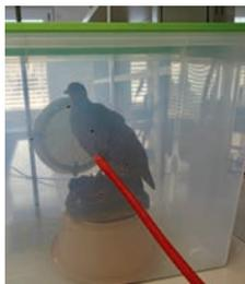
Abb. 2: Probenahmebox zur Untersuchung von arsenbelasteten Feinstaubproben. Simulation von Durchzug, indem Luft am Tier vorbeiströmt und Staub aufwirbelt, der auf dem Filter im hinteren Teil abgeschieden wird.
