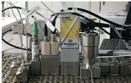
Abb. 1: Mikroreaktoraufbau für heterogen katalysierte Reaktionen
