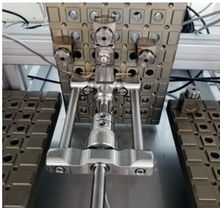
Abb. 2: Aufbau für online Raman-Spektroskopie
