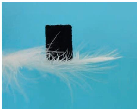
Abb. 1: Demonstration des geringen Gewichts eines Graphen/Carbon Nanofaser Aerogels
