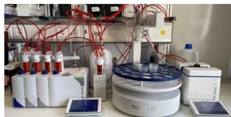
Abb. 2: Setup für die automatisierte  $pK_s$ -Bestimmung mit Geräten von Mettler-Toledo.
