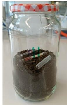
Abb. 1: Beprobung von flüchtigen organischen Verbindungen mit drei verschiedenen Adsorptions-Röhrchen, die für den Feldversuch eingesetzt werden können.
