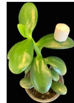
Abb. 2: Cellulose-Nanofaserschwamm mit immobilisierter Lipase. Immobilisierung des Enzyms mittels Crosslinker Glutaraldehyd, Quervernetzung des NFS mit Epichlorhydrin.
