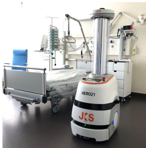
Abbildung 1: Im Unispital Zürich fährt der UV-C-Reini- gungsroboter «Hero21» au- tonom durch die Spitalzim- mer (USZ, 2021).
