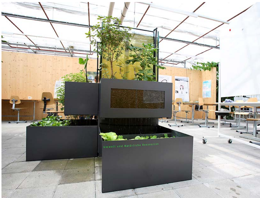
Bild: Modellanlage zur kombinierten Fisch- und Pflanzenzucht (Aquaponic) (Foto: ZHAW Wädenswil)
