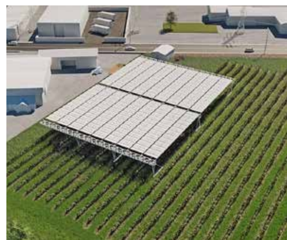
Abb. 2: Ein faltbares Solardach gegen Spätfröste in einem Projektmodell. (© O. Mounir)
