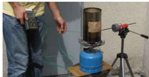
Fig. 2: Messung der Pyrolyse- und Reduktionszeit an einzelnen Holzpartikeln.
